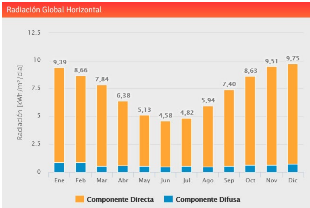
Figura 63. Radiación Solar en la zona de la Subestación Parinas 220 kV
