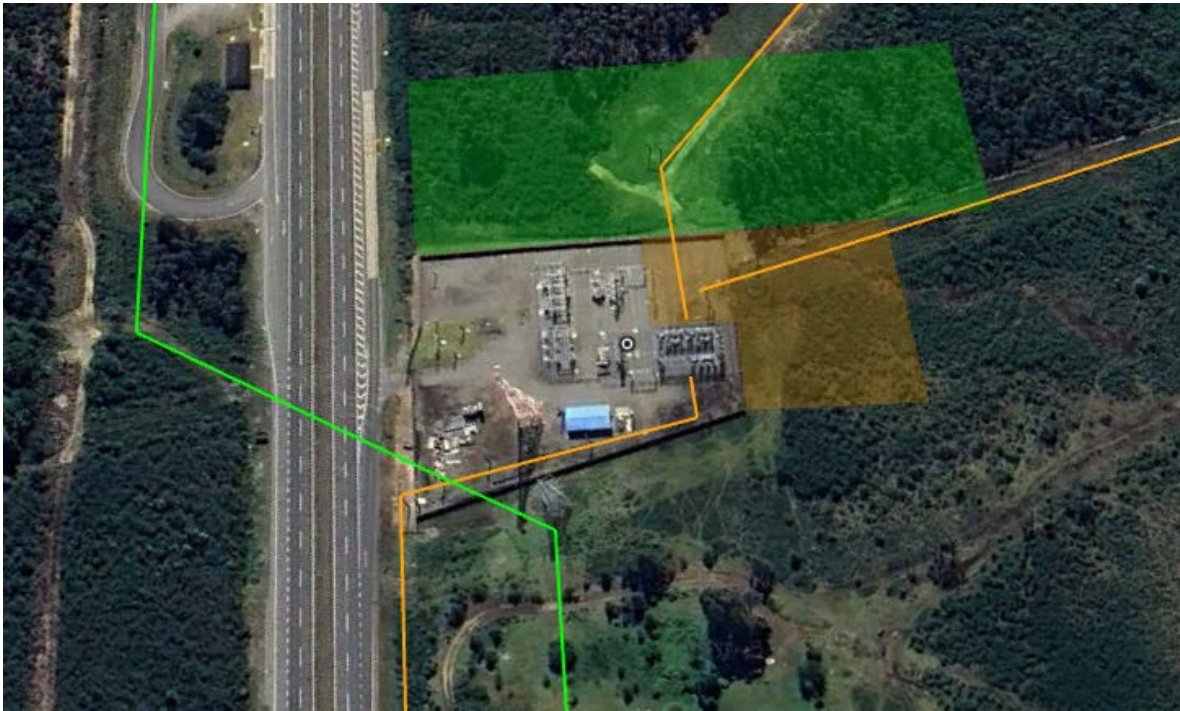
Figura 4: Propuesta de ampliación en S/E El Empalme.
