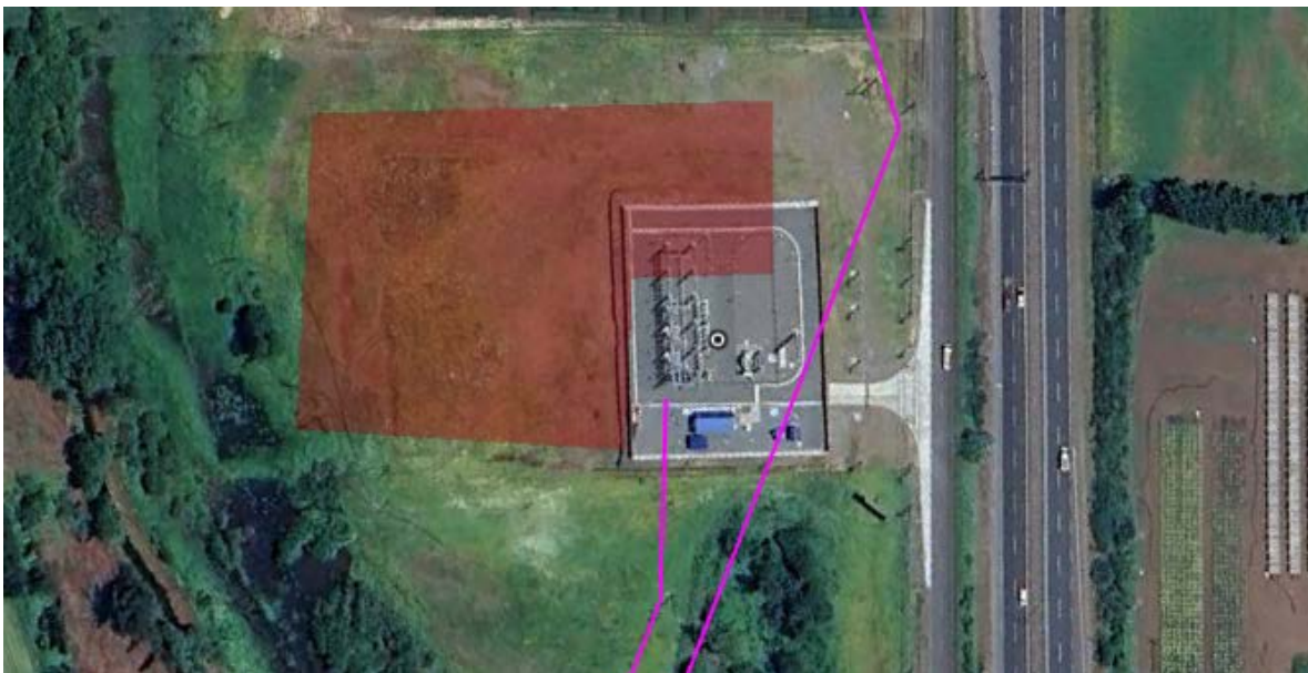
Figura 4: Propuesta de ampliación en S/E Llaima.
