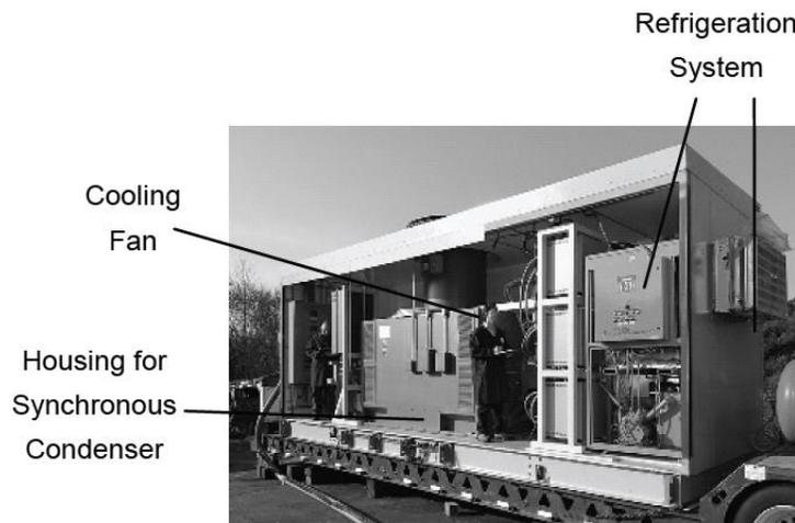
Figura 2.23 Condensador Síncrono en contenedor del fabricante AMSC[18]
