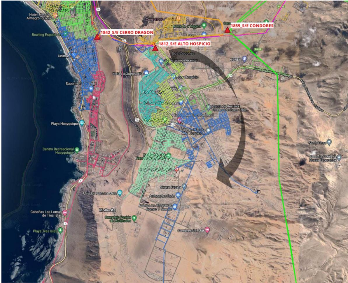
**Figura 8-17: Imagen georreferenciada de la S/E Alto Hospicio, sus alimentadores y el crecimiento esperado de la ciudad**
