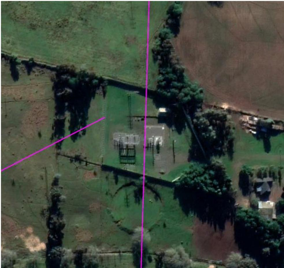
La subestación Los Maquis actualmente cuenta con un patio de 66 kV en configuración barra simple (seccionada por un desconectador) en estructuras tipo parrón y tecnología AIS o Air
