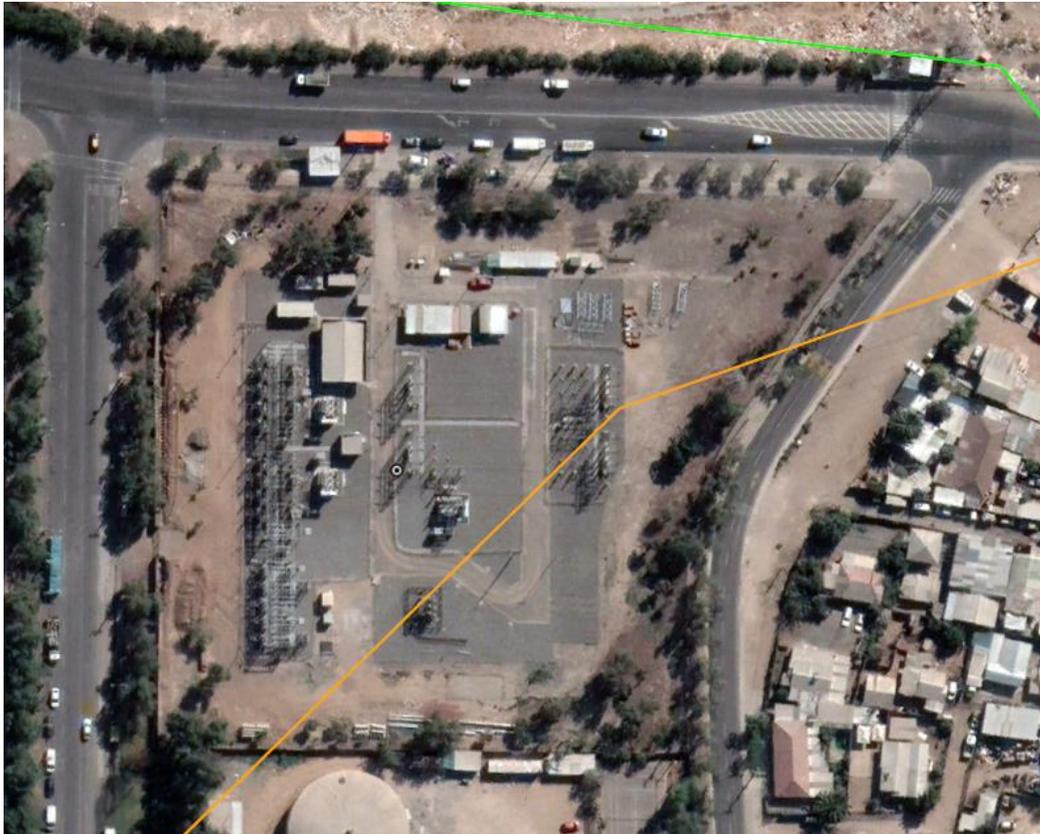
La subestación San Pablo actualmente cuenta con un patio de 110 kV en configuración barra principal seccionada y tecnología AIS o Air Insulated Substation, con tres transformadores de poder, los cuales se enumeran a continuación:
