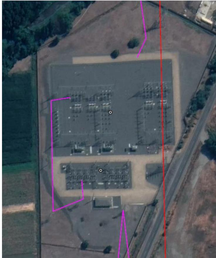
La subestación Malloa Nueva cuenta con un patio de 154 kV en configuración barra principal seccionada, el cual se conecta en derivación a ambos circuitos de la línea 2x154 kV Punta de Cortés – Tinguiririca en el denominado Tap Off Malloa Nueva.
