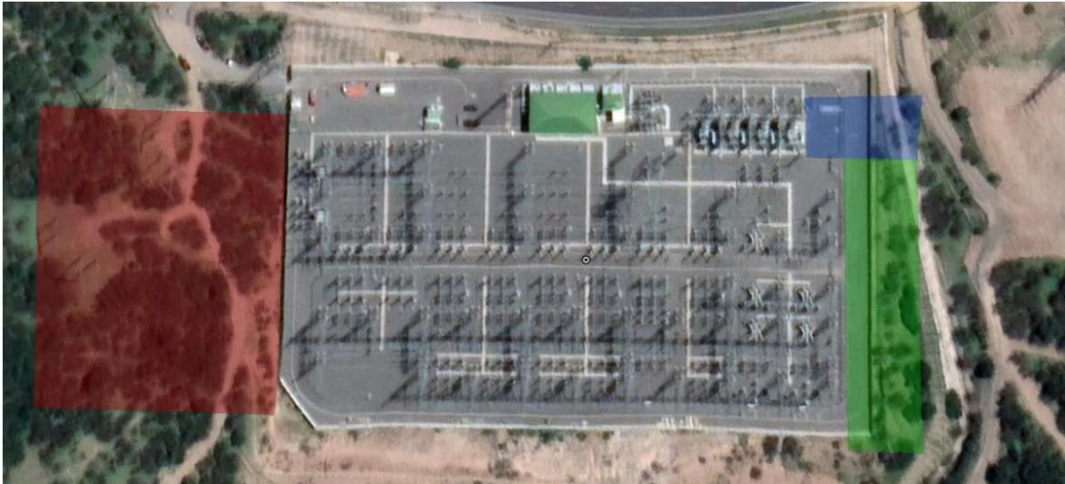
En la imagen anterior, se destaca en verde el sector proyectado para la ampliación en 220 kV, en azul el sector para la instalación del nuevo banco de autotransformadores y en rojo el área involucrada en la ampliación del patio de 154 kV.
