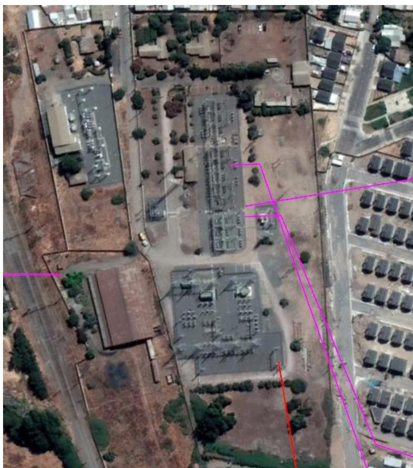
La subestación San Fernando cuenta con un patio de 154 kV en configuración barra simple y tecnología AIS o Air Insulated Substation el cual se conecta en el Sistema Eléctrico Nacional a partir de la línea 2x154 kV Tinguiririca – San Fernando. Cabe mencionar que la línea mencionada anteriormente se conecta como un único circuito a una posición que actualmente no posee interruptor, conectándose a la barra mediante un arreglo de desconectores.
