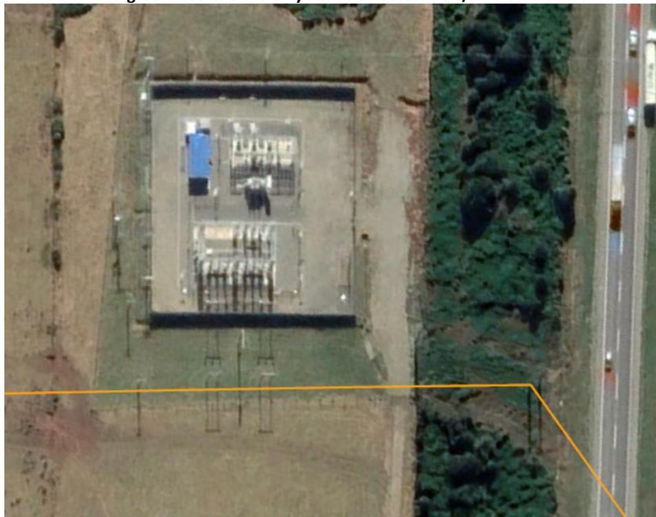
La subestación Dalcahue actualmente cuenta con un patio de 110 kV en configuración barra simple y tecnología AIS o Air Insulated Substation, con un transformador de poder (Transformador N° 1) de 110/23 kV y 16 MVA de capacidad máxima.
