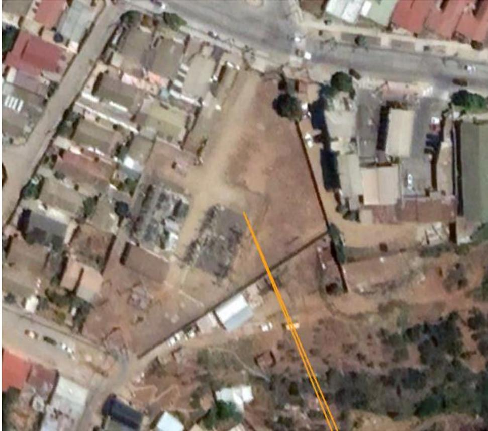
La subestación Los Placeres actualmente cuenta con un patio de 110 kV en configuración barra simple (seccionada mediante un desconectador) y tecnología AIS o Air Insulated Substation, con dos transformadores de poder, los cuales se enumeran a continuación:
