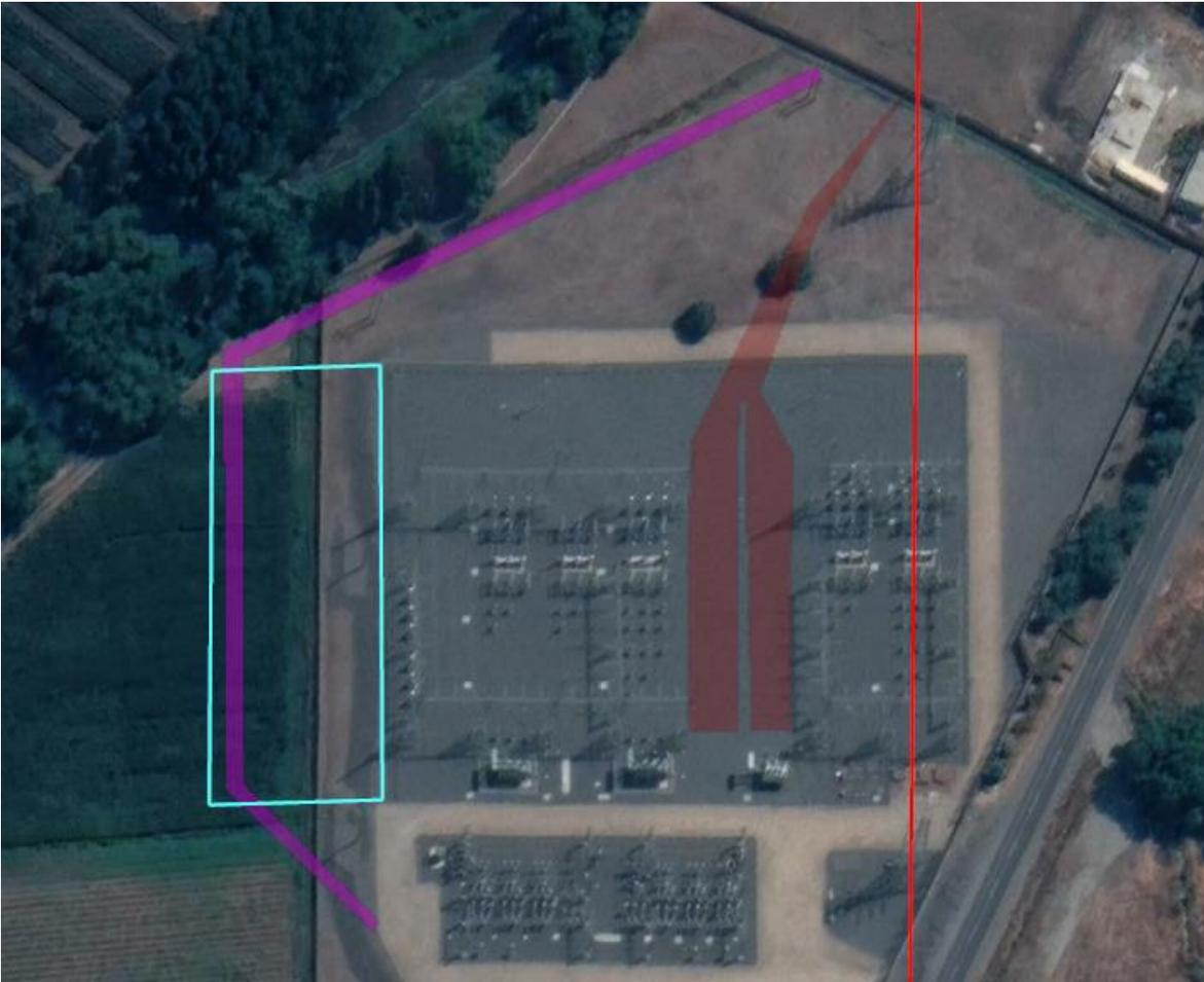
En la figura anterior, se muestra en color rojo la nueva acometida y paños para completar el seccionamiento de la línea 2x154 kV Punta de Cortés – Tinguiririca y en color magenta la reubicación tentativa para el tramo de la línea 1x66 kV Quinta de Tilcoco – Malloa Nueva. A su vez en celeste se muestra el sector propuesto para la ampliación de barras y plataformas para recibir los paños de la nueva línea proveniente de desde subestación Fuentecilla.
