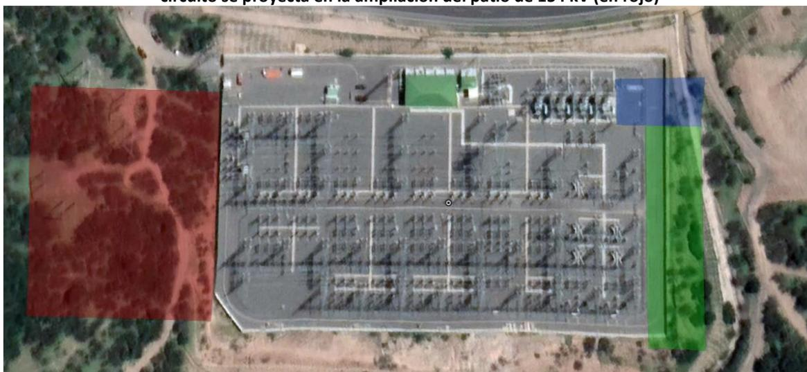
En el caso de la S/E San Fernando, se ha proyectado la construcción de dos paños en configuración barra principal y barra de transferencia para independizar los circuitos de la línea, instalando los equipos en el espacio en barra y plataforma que quedan disponibles a partir de la obra “Ampliación en S/E San Fernando 154 kV (NBP+BT)”.
