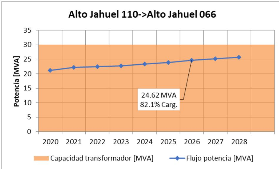
**Figura 8-34: Proyección de demanda máxima y capacidad actual del transformador 110/66 kV en la S/E Alto Jahuel.**
