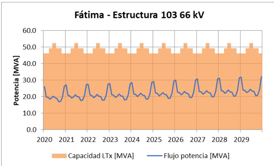
**Figura 8-31:** Flujo de potencia máximo mensual y capacidad de transmisión térmica de la línea 1x66 kV Fátima – Buin (CGE), en el tramo Fátima - Estructura 103.
