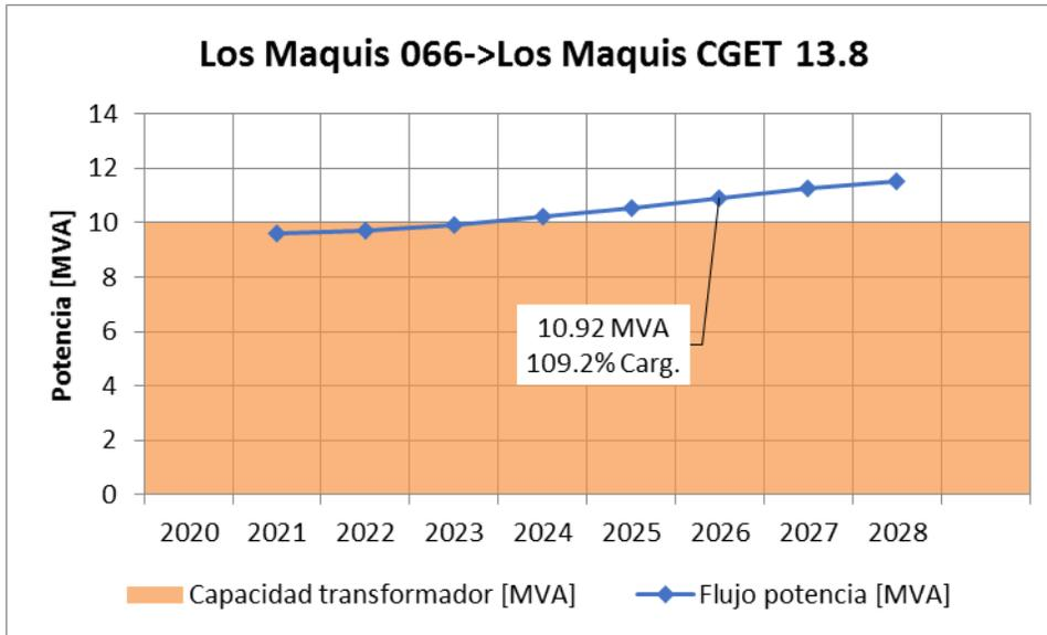
Figura 8-25: Proyección de demanda máxima y capacidad actual del transformador 66/13,2 kV en la S/E Los Maquis (CGE).
