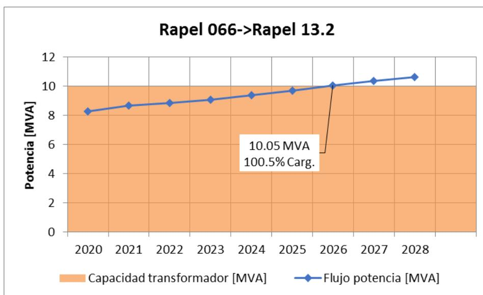
Figura 8-39: Proyección de demanda máxima y capacidad actual del transformador 66/13,2 kV en la S/E Reguladora Rapel.
