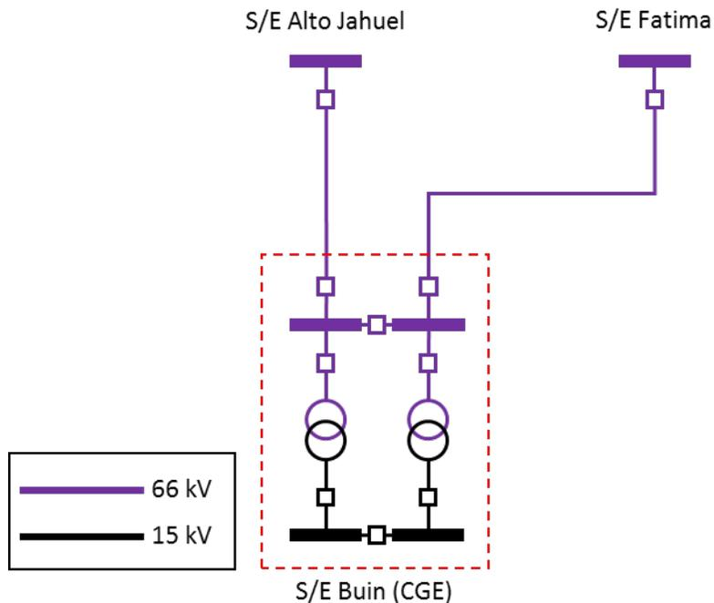
Figura 8-28: Diagrama unilineal simplificado de la conexión actual de la S/E Buin 66/15 kV (CGE).
