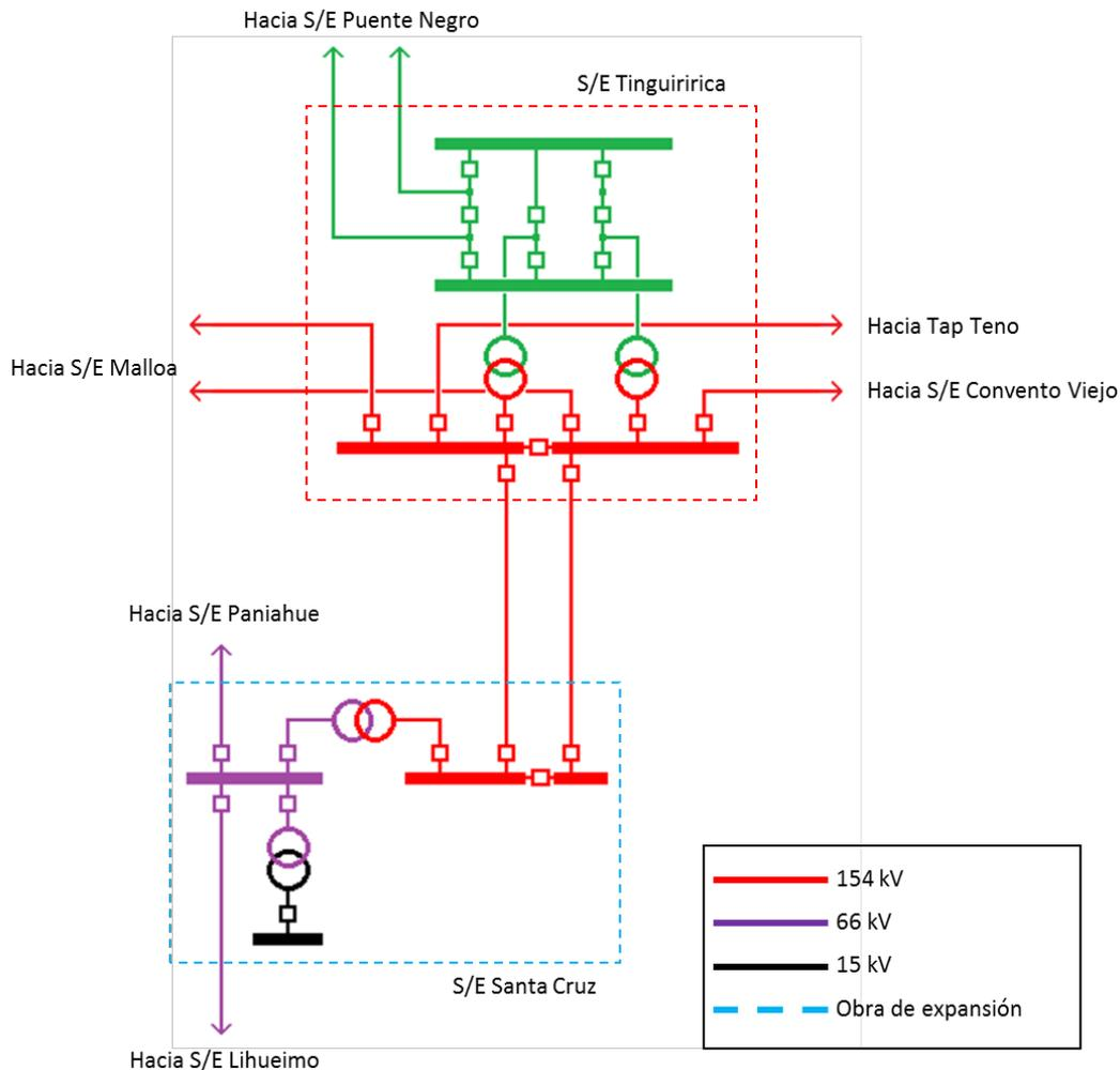
Figura 8-37: Diagrama unilineal simplificado de la ampliación en la S/E Santa Cruz y línea 2x154 kV Tinguiririca – Santa Cruz.
