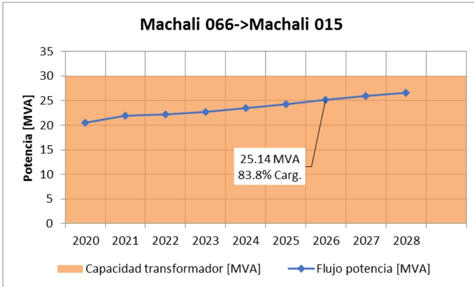
Figura 8-27: Proyección de demanda máxima y capacidad actual del transformador 66/15 kV en la S/E Machalí.
