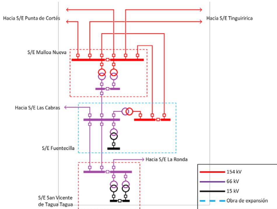
Figura 8-38: Diagrama unilineal simplificado de la ampliación en la S/E Fuentecilla.
