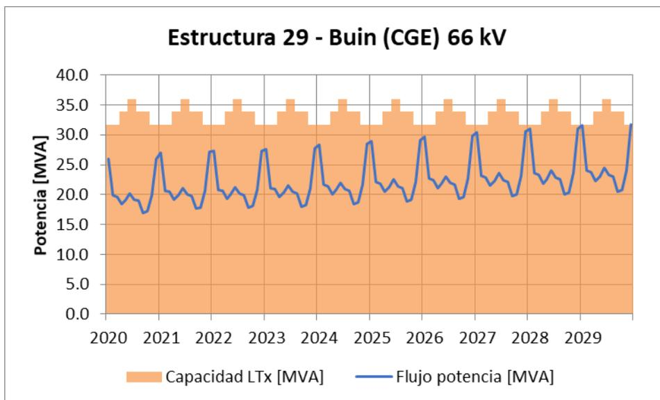
**Figura 8-33: Flujo de potencia máximo mensual y capacidad de transmisión térmica de la línea 1x66 kV Fátima - Buin (CGE), en el tramo Estructura 29 - Buin (CGE).**
