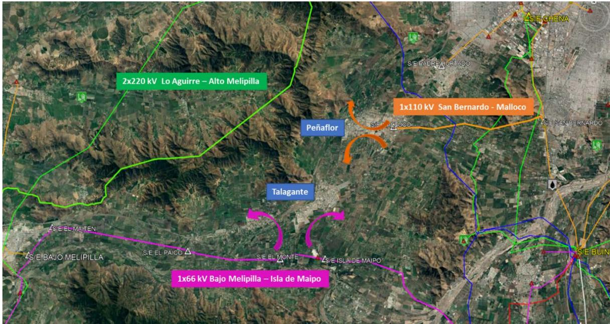
**Figura 8-19: Imagen georreferenciada de la zona de abastecimiento de las LLTT 1x110 kV San Bernardo – Malloco y 1x66 kV Bajo Melipilla – Isla de Maipo**
