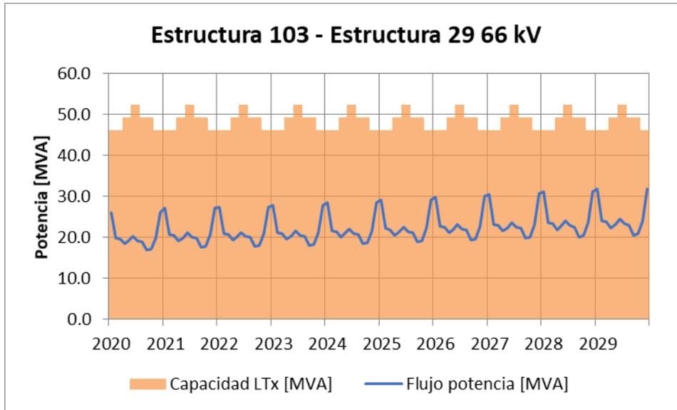
**Figura 8-32: Flujo de potencia máximo mensual y capacidad de transmisión térmica de la línea 1x66 kV Fátima - Buin (CGE), en el tramo Estructura 103 - Estructura 29.**
