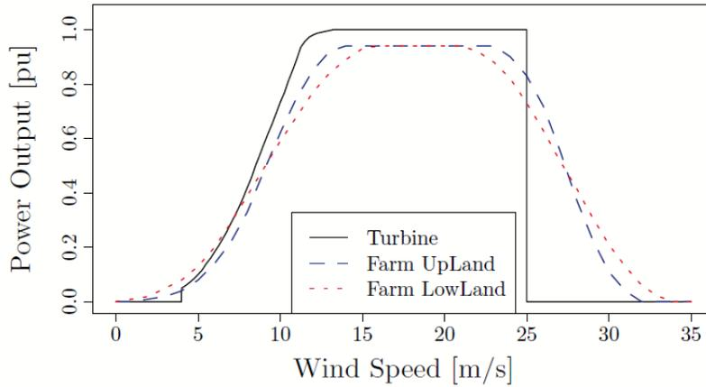
Figura 7-5: Potencia de acuerdo con la velocidad del viento
