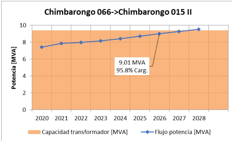
Figura 8-24: Proyección de demanda máxima y capacidad actual del transformador 66/15 kV T2 en la S/E Chimbarongo.
