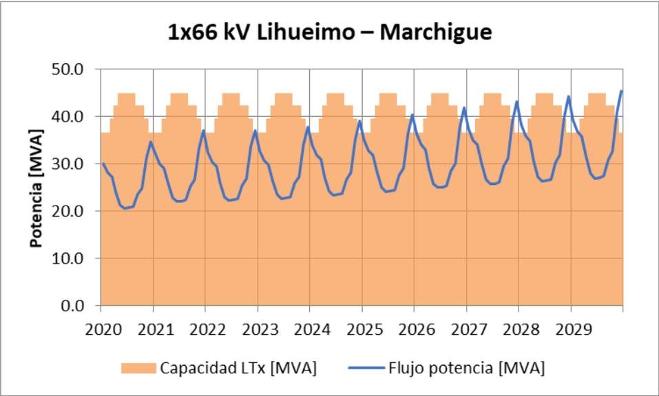
Figura 8-36: Flujo de potencia máximo mensual y capacidad de transmisión térmica de la línea 1x66 kV Lihueimo – Marchigue.
