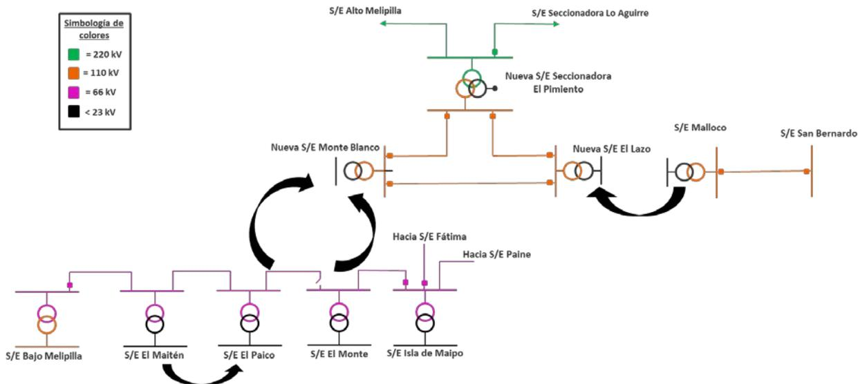
Figura 8-20: Esquema eléctrico del proyecto “Apoyo al Abastecimiento de Peñaflores y Talagante”
