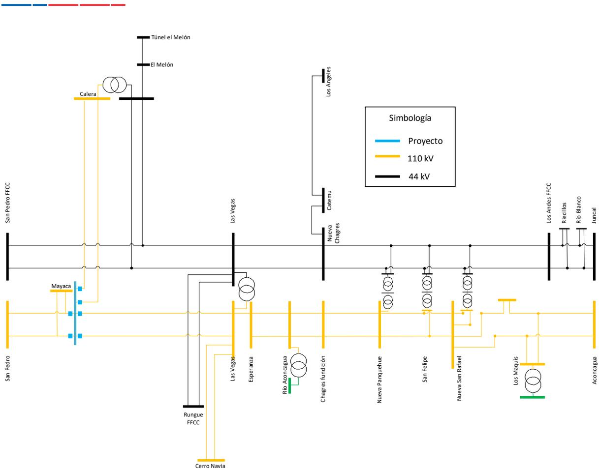
**Figura 8-7: Diagrama unilineal simplificado del proyecto.**
