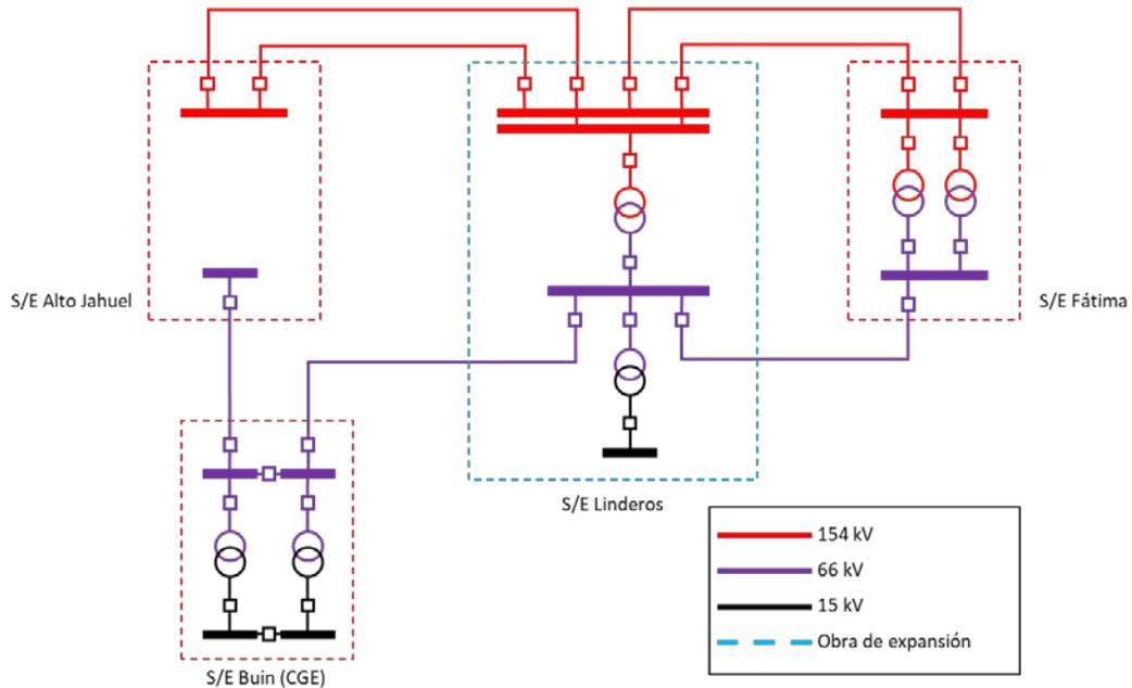
Figura 8-35: Diagrama unilineal simplificado de la nueva S/E Linderos.
