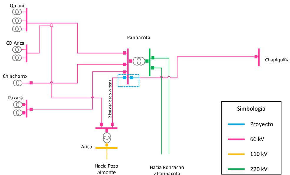
Figura 8-2: Diagrama unilineal simplificado del proyecto
