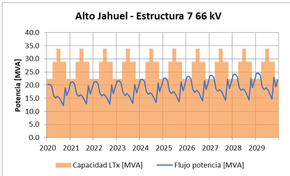
Figura 8-29: Flujo de potencia máxima mensual y capacidad de transmisión térmica de la línea 1x66 kV Alto Jahuel – Buin (CGE), en el tramo Alto Jahuel – Estructura 7.
