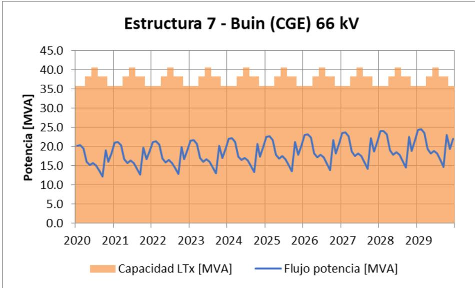
**Figura 8-30:** Flujo de potencia máximo mensual y capacidad de transmisión térmica de la línea 1x66 kV Alto Jahuel – Buin (CGE), en el tramo Estructura 7 – Buin (CGE).
