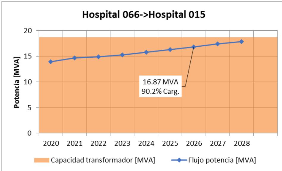
Figura 8-26: Proyección de demanda máxima y capacidad actual del transformador 66/15 kV en la S/E Hospital.
