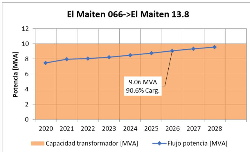
Figura 8-18: Proyección de demanda y capacidad actual del transformador 66/13,8 de 10 MVA de S/E El Maitén
