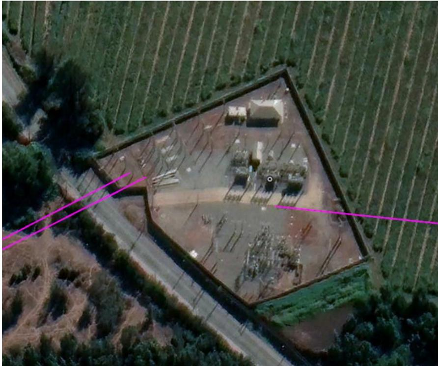
La subestación Isla de Maipo actualmente cuenta con un patio de 66 kV en configuración barra principal seccionada y tecnología AIS o Air Insulated Substation, con tres transformadores de poder, los cuales se enumeran a continuación:
