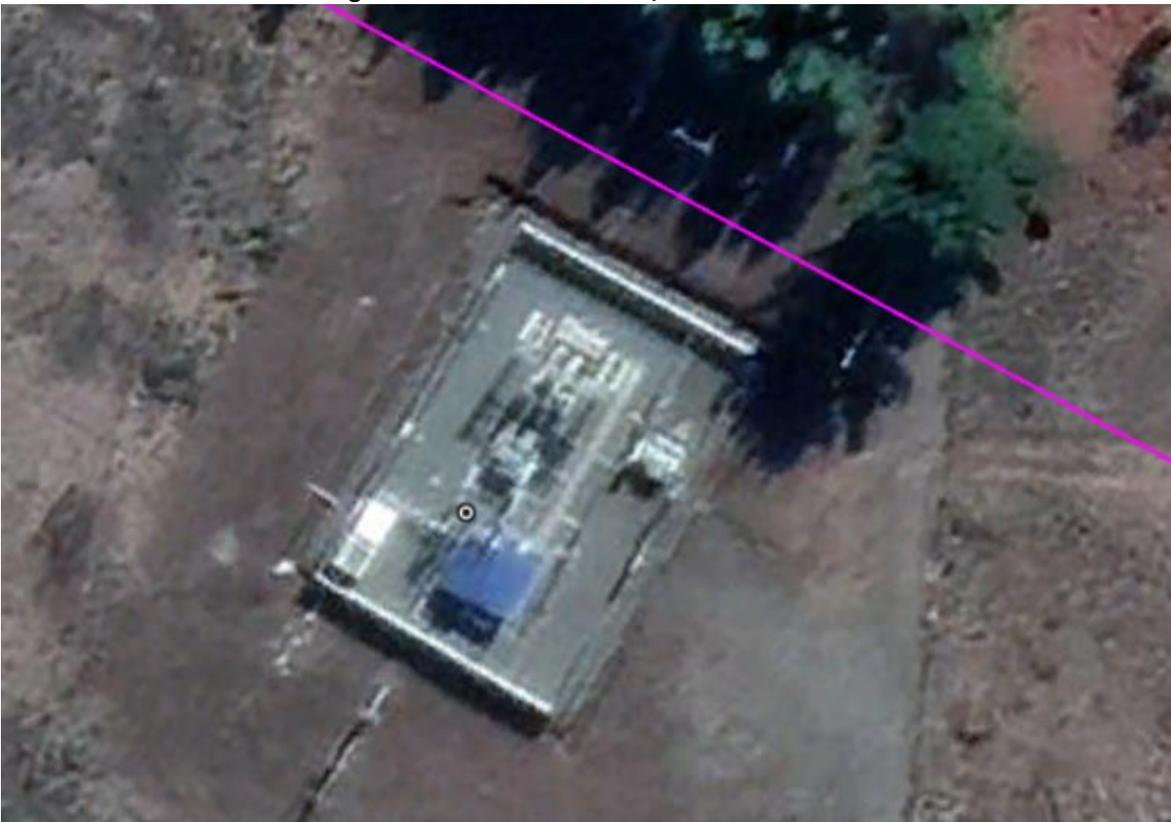
La subestación Santa Bárbara, actualmente no cuenta con patio de alta tensión, posee un transformador de poder con nivel de tensión 66/13,8 kV de 5 MVA de capacidad máxima, que se conecta directamente a la línea simple circuito 1x 66 kV Duqueco - Faenas Pangue a través de una conexión en derivación. La subestación cuenta con una sala de celdas de media tensión de 13,8 kV, en configuración barra simple, a la cual se conecta el transformador.
