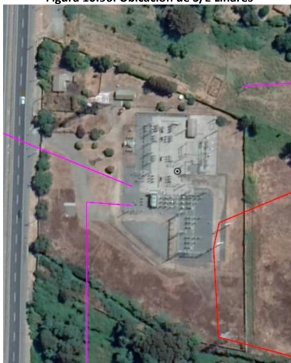
La subestación Linares actualmente cuenta con un patio de 154 kV en configuración barra simple y tecnología AIS o Air Insulated Substation, con un transformador de poder (Transformador N° 1) de razón de transformación 154/66 kV y 75 MVA de capacidad máxima. Este equipo cuenta con paños de conexión en ambos niveles de tensión.
