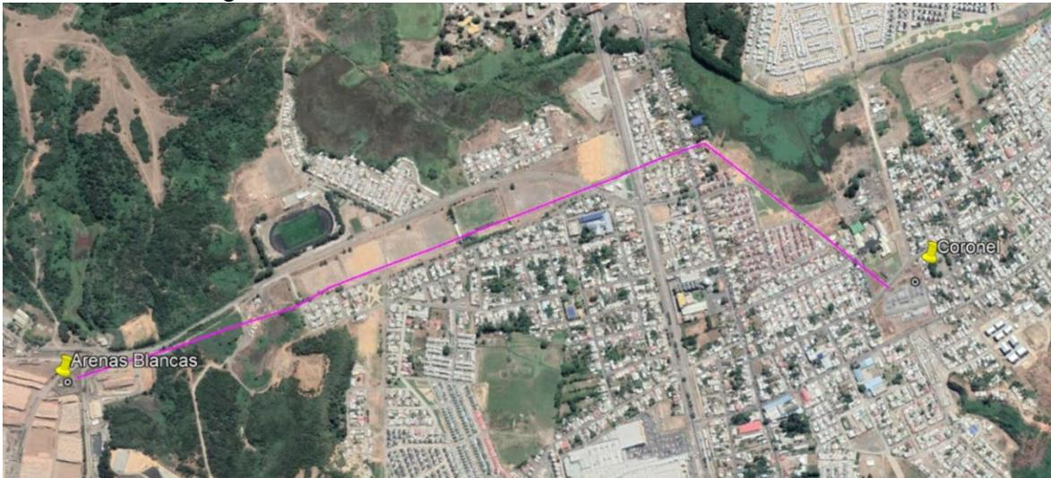
La línea tiene una longitud aproximada de 2,6 km, con alrededor de 19 estructuras, de las cuales algunas son de doble circuito pues el tendido a intervenir comparte estructuras en un tramo con la línea 1x66 kV Coronel – Bocamina. El conductor actual de la línea corresponde a un AAAC 312,8 MCM (Butte).
