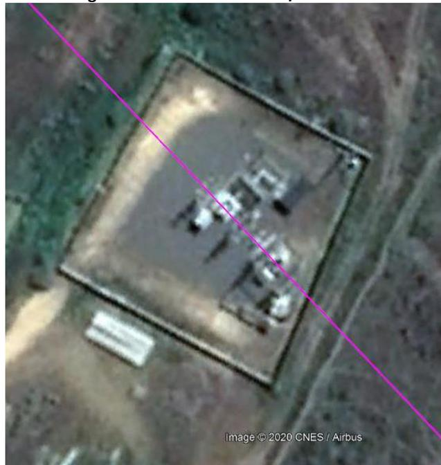
La subestación Parronal, actualmente está conformada por un transformador regulador AT2 66/66 kV 15 MVA a la entrada de la línea 1x66 kV Los Maquis (CGE) – Hualañé a la subestación, un transformador de retiro T1 66/13,8 kV de 5 MVA de capacidad máxima,
