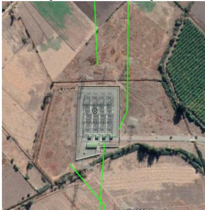
La subestación Nogales actualmente cuenta con un patio de 220 kV en configuración interruptor y medio y tecnología AIS o Air Insulated Substation, y se encuentra conectada en el Sistema Eléctrico Nacional a través de las líneas 2x220 kV Nogales – Los Vilos, 2x220 kV Quillota – Nogales, 2x220 kV Polpaico – Nogales y 2x220 kV Nogales – Ventanas.
