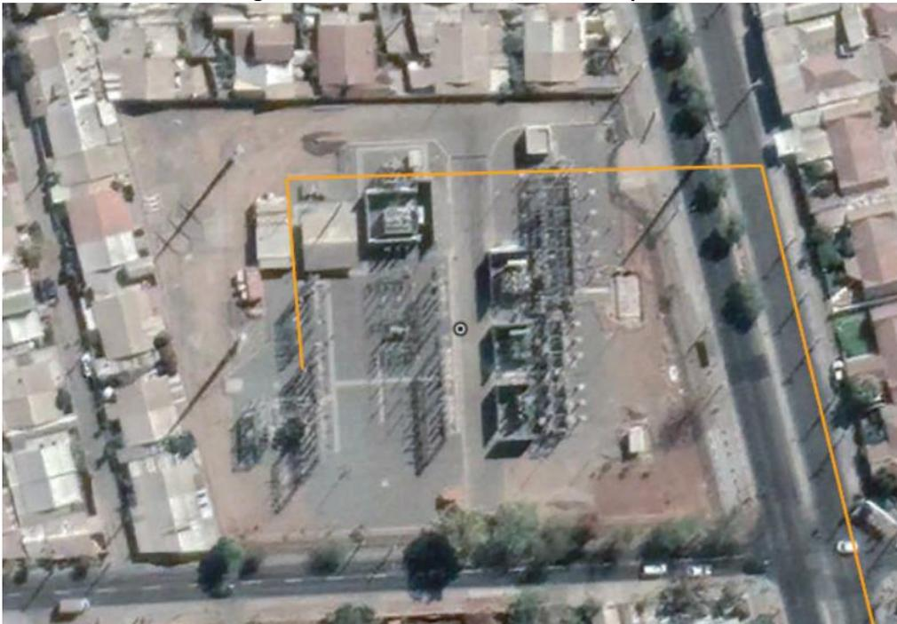
La subestación Santa Raquel actualmente cuenta con un patio de 110 kV en configuración barra principal seccionada y tecnología AIS o Air Insulated Substation, con cinco transformadores de poder, los cuales se enumeran a continuación:
