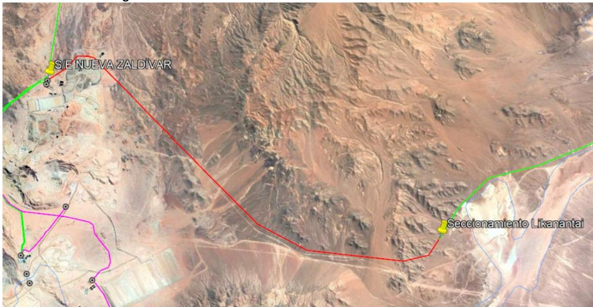
La línea tiene una longitud aproximada de 30 km, con alrededor de 83 estructuras de doble circuito y posee un conductor ACAR 1100 MCM.
