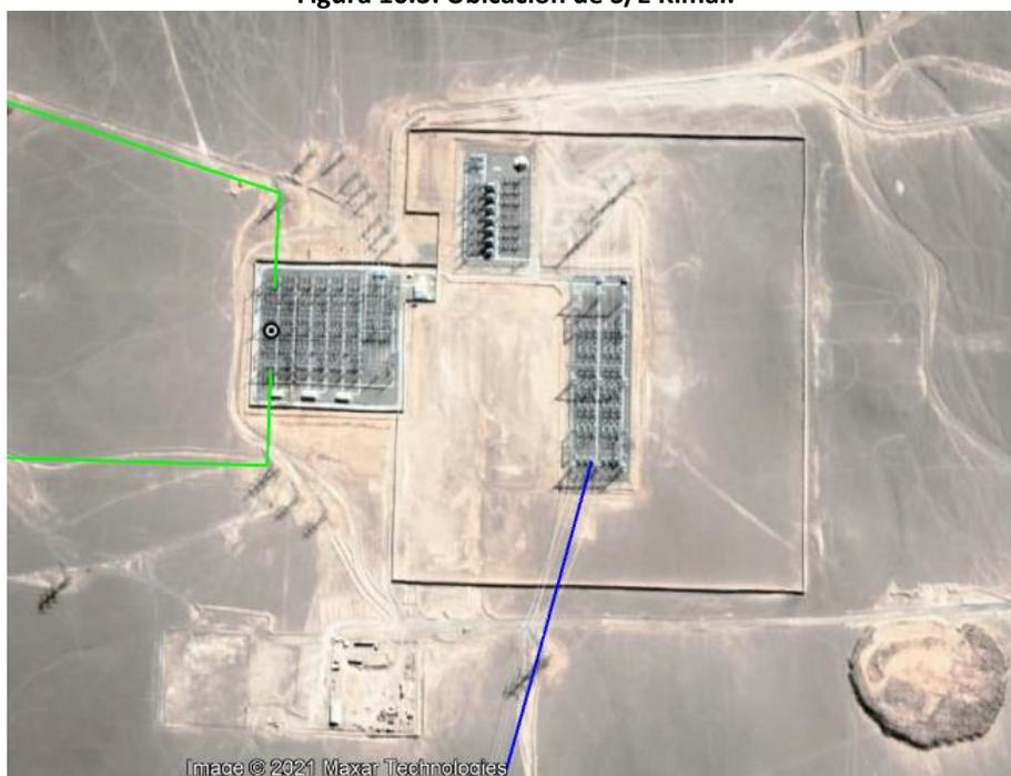
La subestación Kimal actualmente cuenta con un patio de 500 kV y 220 kV, ambos en configuración interruptor y medio y tecnología AIS o Air Insulated Substation, con dos transformadores de poder 500/220 kV de 750 MVA de capacidad máxima más una unidad de reserva.
