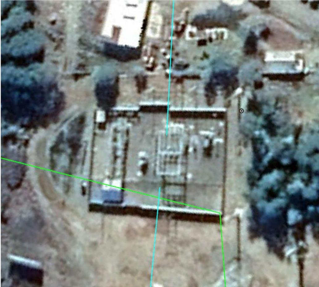
La subestación Pichirropulli actualmente cuenta con un patio de 66 kV en configuración barra simple y tecnología AIS o Air Insulated Substation, con dos transformadores de poder, el Transformador N° 1, 66/13,2 kV de 5 MVA de capacidad máxima y el Transformador N° 2, 66/23 kV de 10 MVA de capacidad máxima.
