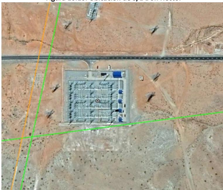
La subestación Don Héctor actualmente cuenta con un patio de 220 kV en configuración interruptor y medio, con diagonales que utilizan equipamiento híbrido o HIS (Hybrid Insulated Substation), y se encuentra conectada en el Sistema Eléctrico Nacional a través de las líneas 2x220 kV Don Héctor – Maitencillo, 2x220 kV Punta Colorada – Don Héctor y 1x220 kV Don Héctor – El Pelicano.
