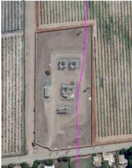
La subestación Rosario actualmente cuenta con un patio de 66 kV en configuración barra simple con barra auxiliar y tecnología AIS o Air Insulated Substation, con un transformador de poder (Transformador N° 1) de razón de transformación 66/15 kV y 30 MVA de capacidad máxima. Este equipo cuenta con paños de conexión en ambos niveles de tensión.
