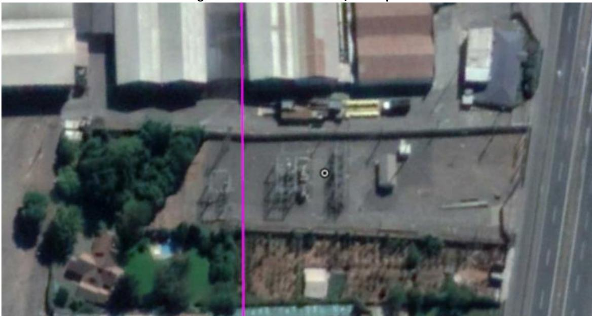
La subestación Rauquén actualmente cuenta con un patio de 66 kV en configuración barra simple con barra auxiliar y tecnología AIS o Air Insulated Substation, con dos transformadores de poder (Transformador N° 1 y N° 2) de razón de transformación 66/13,2 kV y 25 MVA de capacidad máxima cada uno. Ambos equipos cuentan con paños de conexión en sus respectivos niveles de tensión.
