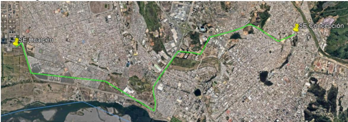
La línea tiene una longitud aproximada de 11 km, con alrededor de 66 estructuras de simple circuito, siendo el conductor actual de la línea un ACAR 900 MCM.
