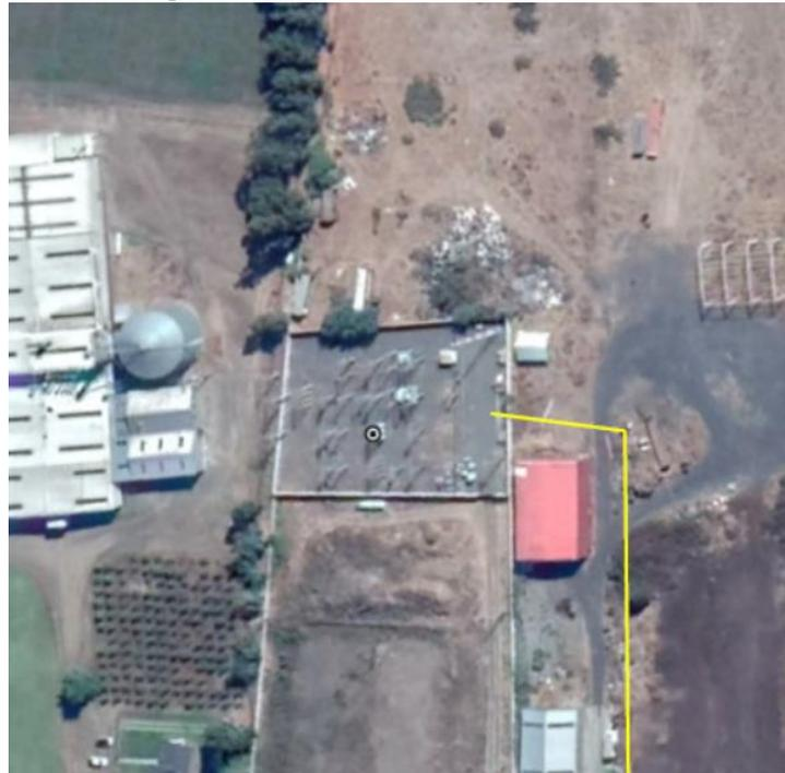
La subestación Santa Elisa actualmente cuenta con un patio de 33 kV en configuración barra simple y tecnología AIS o Air Insulated Substation, con dos transformadores de poder:
