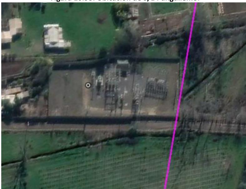
La subestación Panguilemo actualmente cuenta con un patio de 66 kV en configuración barra simple con barra auxiliar y tecnología AIS o Air Insulated Substation, con un transformador de poder (Transformador N° 1) de razón de transformación 66/15 kV y 9 MVA de capacidad máxima. Este equipo cuenta con paños de conexión en ambos niveles de tensión.
