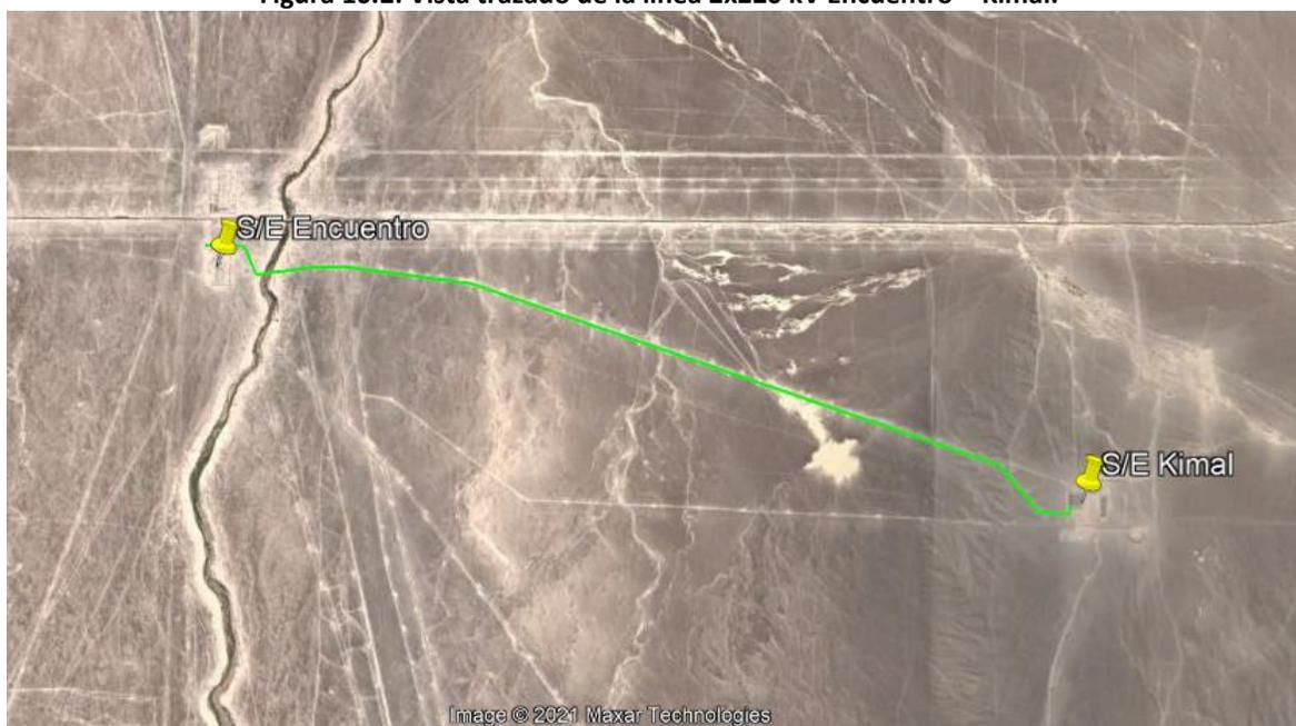
Esta línea tiene una longitud aproximada de 10,08 km, con 44 estructuras de doble circuito, 10 de ellas del tipo anclaje. La línea cuenta con dos conductores, uno corresponde al tipo ACAR 900 y dos conductores por fase entre la estructura 40 y la subestación Kimal, de aproximadamente 9,86 km, y el otro conductor corresponde al tipo AAAC DOVE y dos conductores por fase entre la estructura 40 y la subestación Encuentro, de aproximadamente 0,21464 km.
