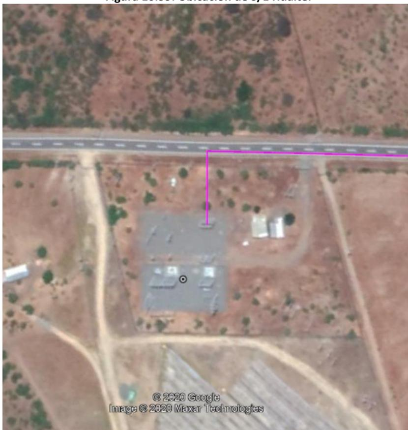
La subestación Hualte actualmente cuenta con un patio de 66 kV en configuración barra simple y tecnología AIS o Air Insulated Substation, con tres transformadores de poder, los cuales se enumeran a continuación:
