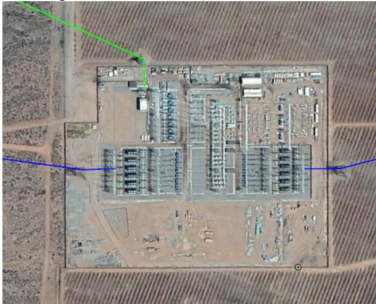
La subestación Nueva Pan de Azúcar actualmente cuenta con un patio de 500 kV en configuración interruptor y medio y tecnología GIS o Gas Insulated Substation, de tipo intemperie, con un banco de autotransformadores de razón de transformación 500/220 kV y 750 MVA de capacidad máxima, con unidad de reserva compartida. Este equipo cuenta con paños de conexión en ambos niveles de tensión. Adicionalmente, se conectan al patio
