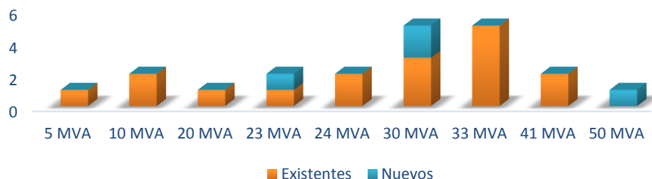
Figura 5.5 Cantidad de transformadores según capacidad
