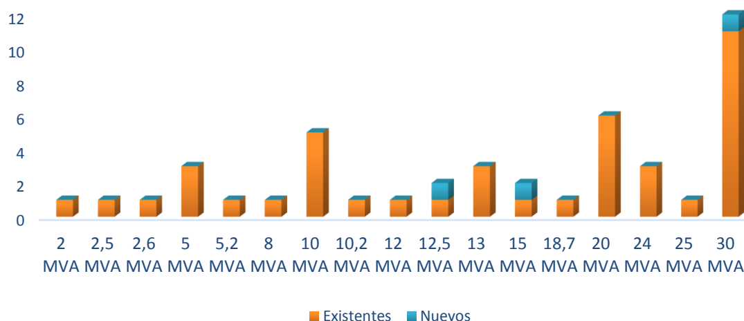
Figura 5.25 Cantidad de transformadores según capacidad
