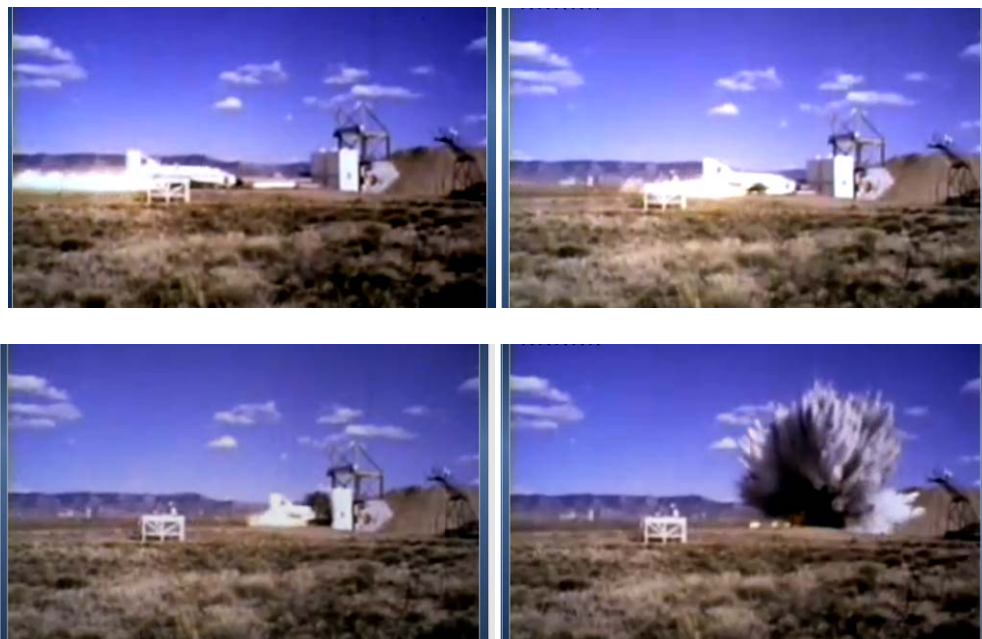
Imagen 4.5 - Secuencia gráfica de la prueba de impacto sobre una estructura similar a la del recinto de contención de una central nuclear de un avión de combate Phantom F-4.
