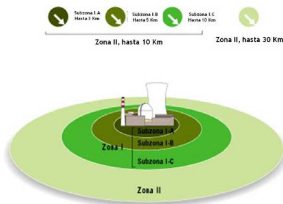
Figura 4.4 - Representación esquemática de las zonas consideradas dentro de los planes de emergencia nuclear de una central nuclear.
