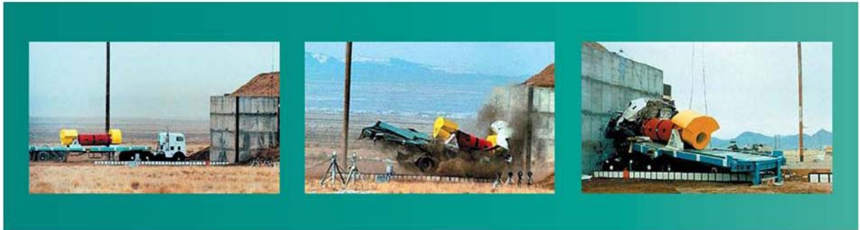
Figura 3.10 - Pruebas de impactos realizadas a contenedores de transportación del combustible nuclear.
