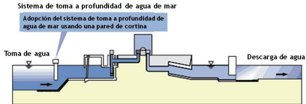
Figura 3.2 - Representación esquemática de la toma de agua de mar a profundidad.
