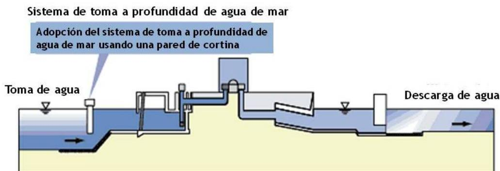
**Figura 7.3** - Representación esquemática de la toma de agua de mar a profundidad.
