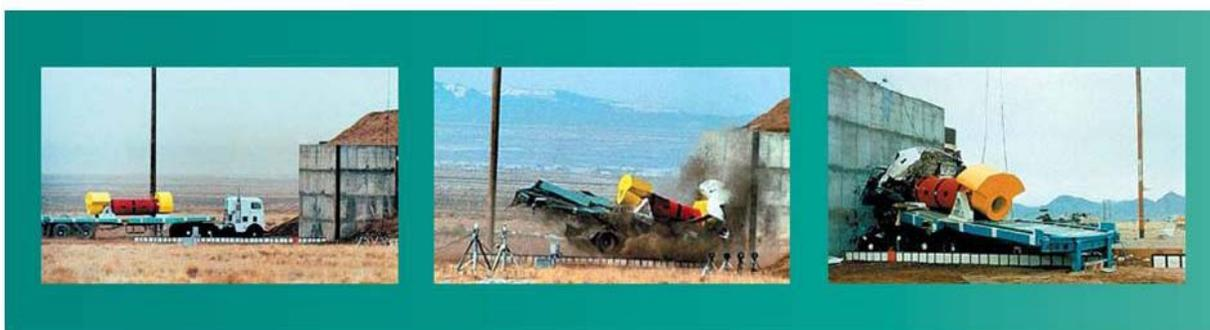
**Figura 4.9** - Pruebas de impactos realizadas a contenedores de transportación del combustible nuclear.
