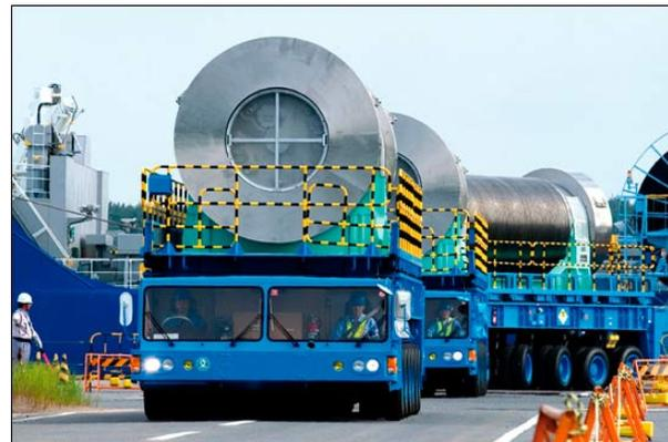
**Figura 4.8** - Manipulación contenedores combustible gastado y transportación por carretera.
