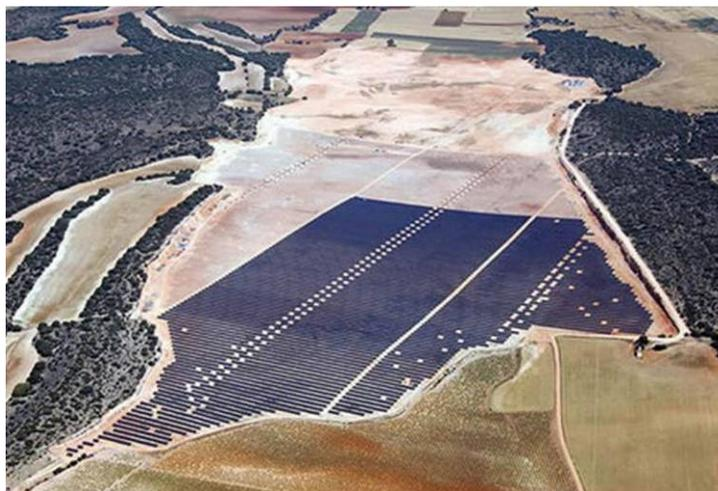
**Imagen 7.2** - Central Solar de Cuenca (España), compuesta por 90 mil paneles solares que cubren 80 hectáreas, equivalente a 100 canchas de fútbol, para producir 18 MW.
