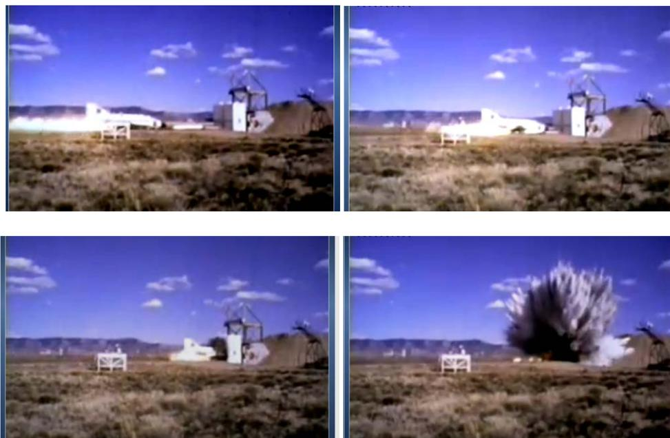
**Imagen 11.2** - *Secuencia gráfica de la prueba de impacto sobre una estructura similar a la del recinto de contención de una central nuclear de un avión de combate Phantom F-4.*
