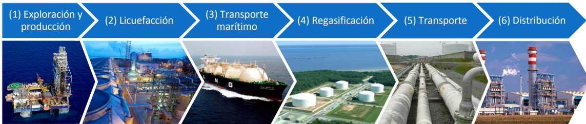
Figura 4: Componentes de la cadena de suministro del GNL
