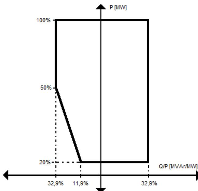
Por debajo de  $20\%$   $P_{nom}$ , la estación convertidora no está obligada a inyectar o absorber potencia reactiva.
